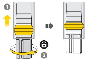
Inserire la pompa nel reggisella e girare la manopola di chiusura per chiudere l'anello in gomma. (NON inserire completamente la pompa nel reggisella.)
